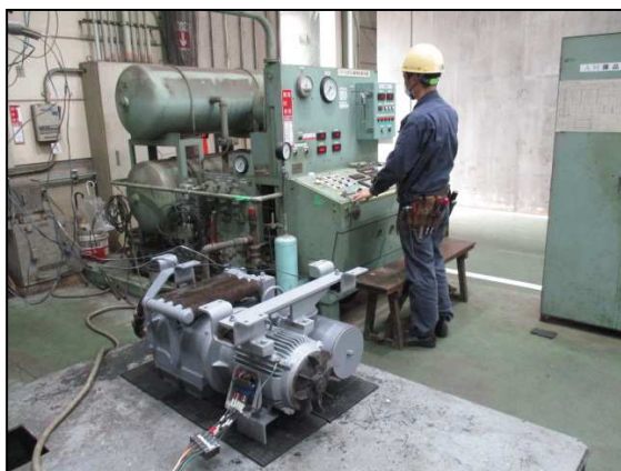
電動空気圧縮機の検査
