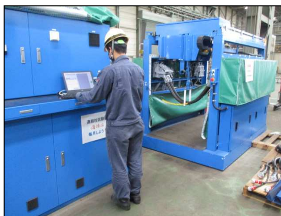
連結栓の検査
