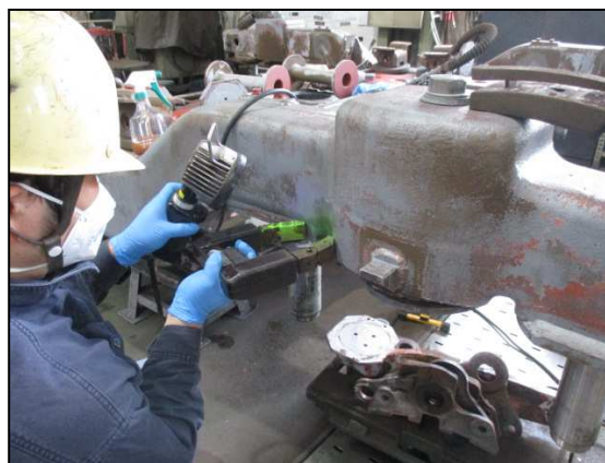
台車枠の検査（磁粉探傷検査）
