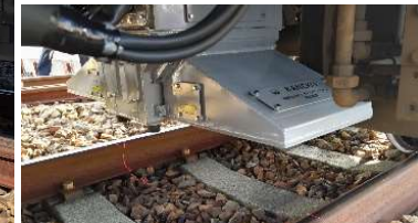
軌道変位モニタリング装置
