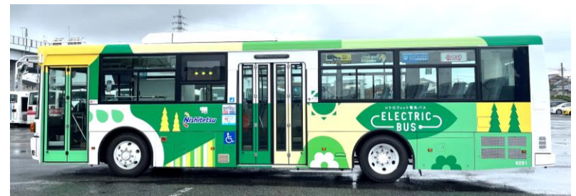
中古バス車両を電動化した「レトロフィット電気バス」
